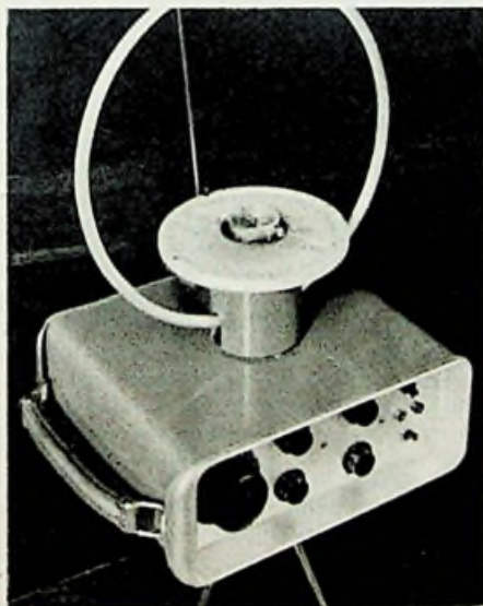
Daß auch zahlreiche Peilgeräte für Fuchsjagden auf dem Gerätewettbewerb zu sehen waren, versteht sich von selbst. Den 6. Preis erhielt diese interessante Konstruktion mit einem Gradpeiler von Engelmann, Radio-Club, München
